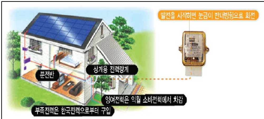
(그림7) 태양광 주택 시스템 구성도
