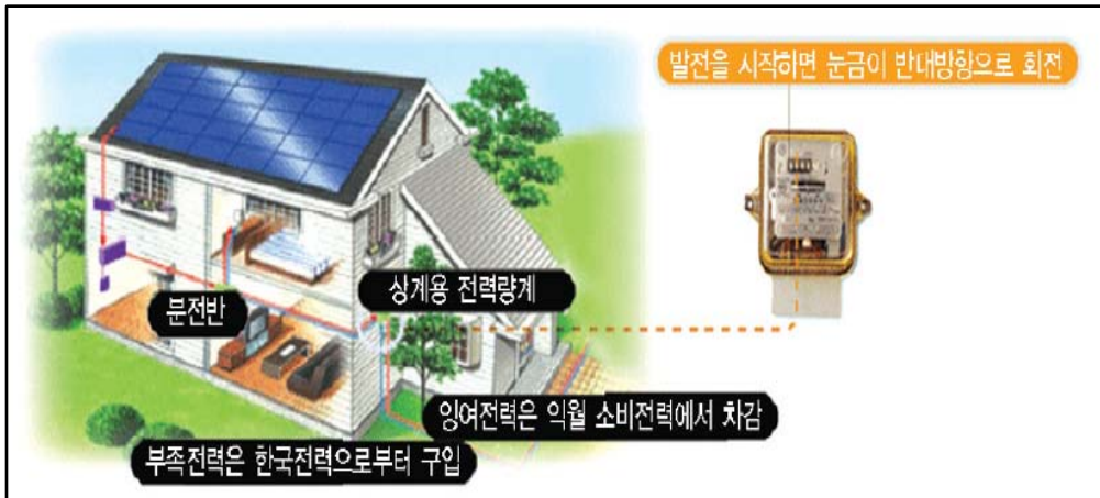
(그림7) 태양광 주택 시스템 구성도
