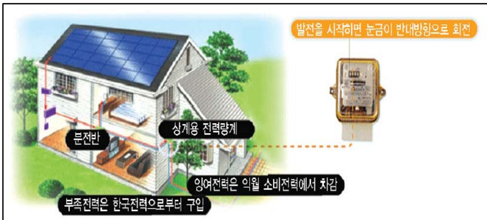
(그림7) 태양광 주택 시스템 구성도
